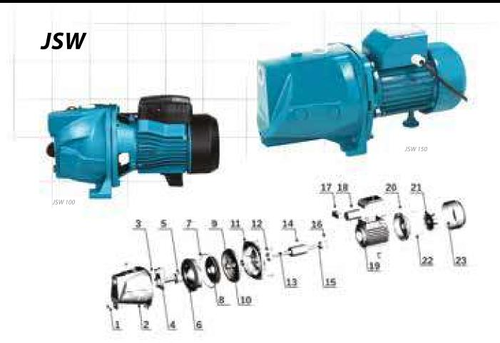
$Einstufige, selbstansaugende\ Kreiselpumpen, die\ mit\ einem\ Venturi-Rohr\ ausgestattet\ sind,$ erhöhen die Saugleistung und dienen zum Pumpen von sauberem, kaltem Wasser aus eigenen Wasserent-nahmestellen und zur Druckerhöhung. Die Pumpen der JSW-Serie sind sehr effizient und haben zusätzlich eine extrem gute Wasseransaugleistung. JSW 200-Pumpen haben einen Rotor aus Messing. Alle Pumpen der JSW-Serie sind mit einem Wärmeschutz ausgestattet, der in der Motorwicklung montiert ist.
